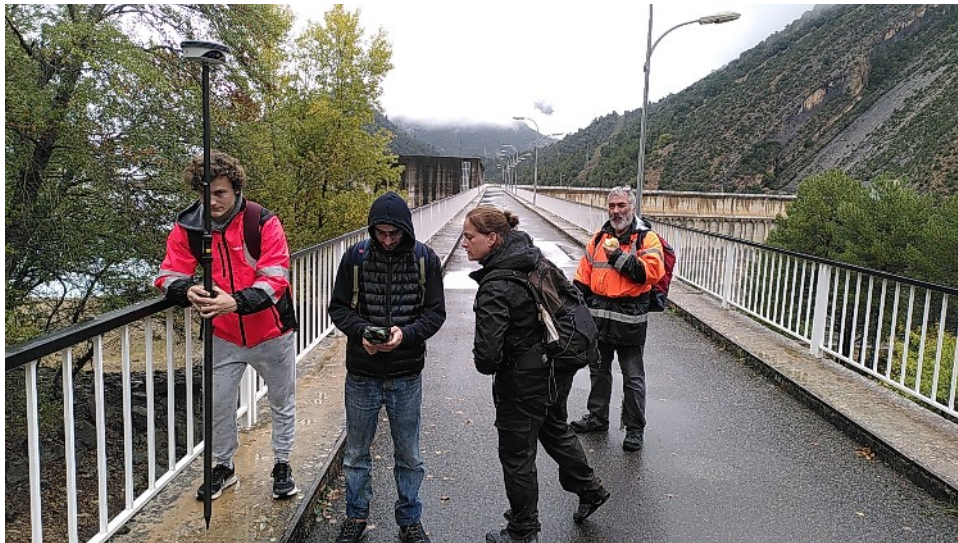
Mesure de calibration du GPS de précision sur un repère d'altitude du barrage
