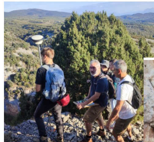
Mesures au GNSS pour assurer le géoréférencement
