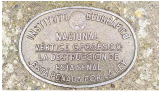
Le repère géodésique de ce point élevé avec sa plaque bien compréhensible
