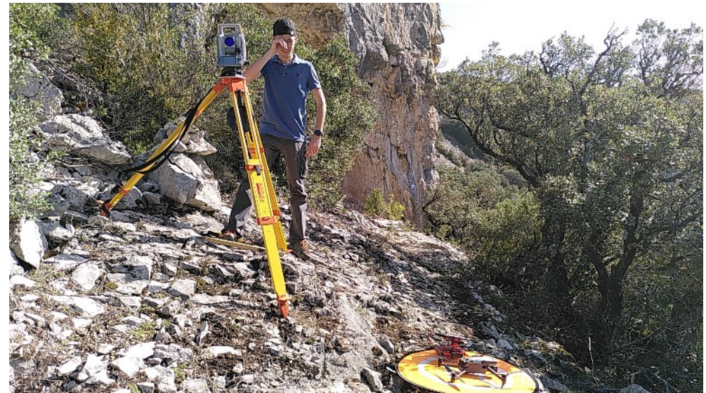
Des mesure tachéométriques rendues délicates par la pente , les rochers ...
